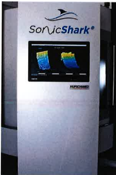
Bild 2 > Der Sonicshark-Rechner ist auf einer Stele auf Rollen angebracht, die neben der Werkzeugmaschine positioniert wird (© Hufschmied)
