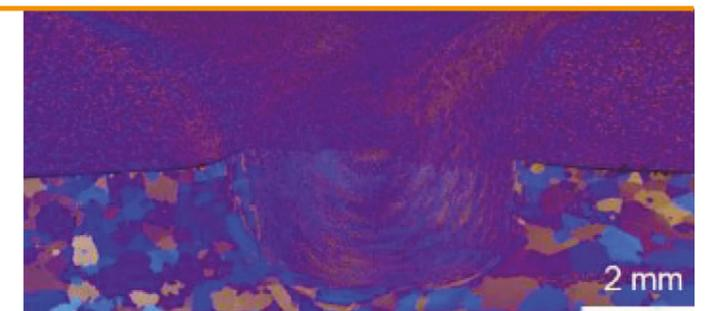
Dünn ausgeprägte Schweißnaht - schmaler Trichter. Probe wurde mit einer stehenden Schulter geschweißt.
