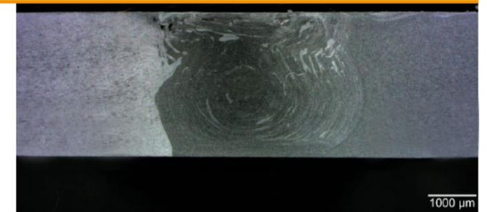
Vermischung der beiden Materialien noch nicht optimal, Pin sollte versetzt werden.
