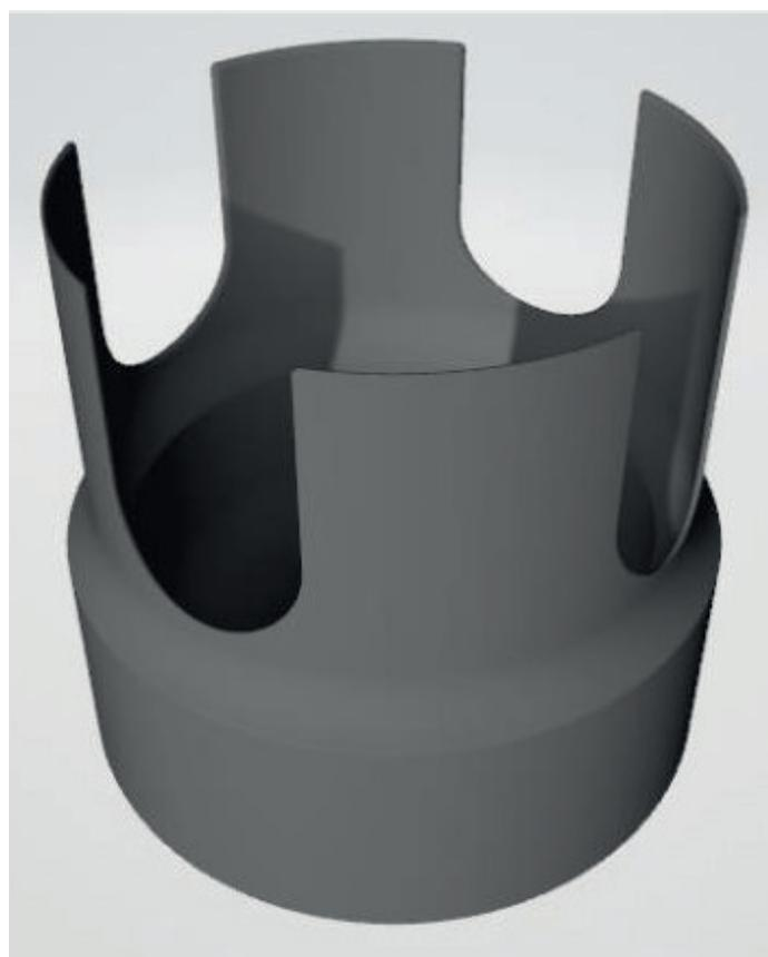
Abbildung 1: STL-Datei der Merlon-Testkrone
